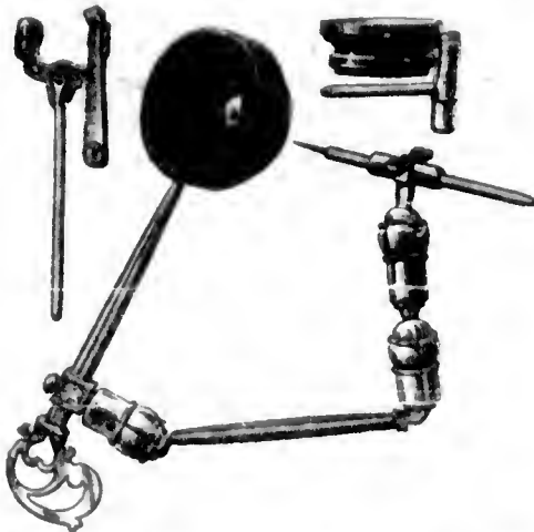
MUSSCHENBROEK'S SIMPLE MICROSCOPE (1702).
